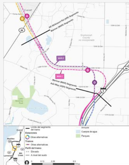
El segmento Mariner se extiende desde aproximadamente la 134th Street SW hasta el área al sur de la SR 99. Las alternativas de ruta, MAR-1 y MAR-2, se muestran en rosa y púrpura, y las alternativas de estación se muestran como opciones B y D. | Haga clic sobre la imagen para ampliarla
