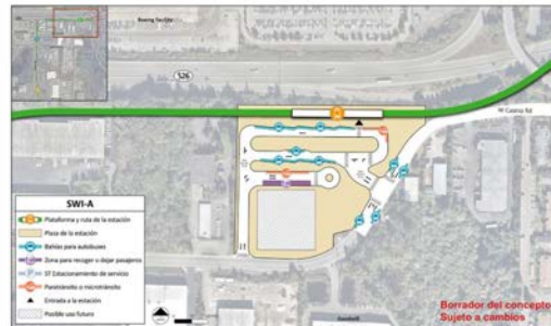
Plano inicial de la estación alternativa SWI-A, una estación elevada situada justo al sur de SR 526 cruzando la autopista de Boeing. | Haga clic en la imagen para ampliarla
