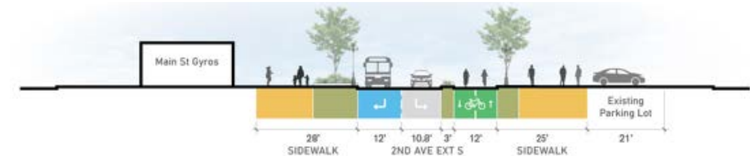
圖4.07. Stitch重點地區：AA' 部分。第二大道南延段示意街道剖面圖，展示提議中的多模式改善項目，包括分隔式自行車設施、拓寬人行道、行道樹和雨水管理設施。
