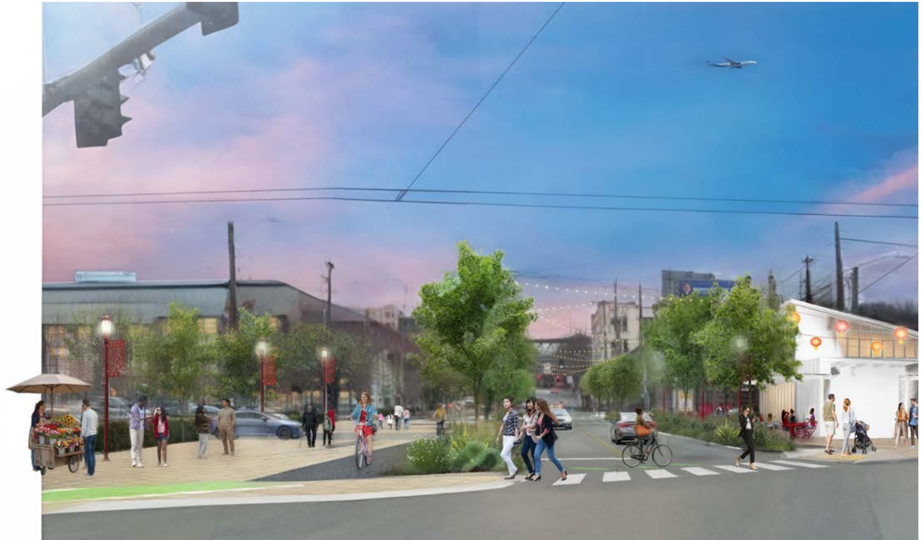
Hình 4.29. Hình Minh Họa Khu Vực Dearborn. Góc nhìn tái định hình của giao lộ S Dearborn St và Seattle Blvd thể hiện một tầm nhìn khả thi. Theo đó, mặt đường được thu hẹp để tạo không gian rộng rãi cho việc đi bộ và đi xe đạp, một trạm đường sắt nhẹ mới tiềm năng và sự phát triển theo định hướng sử dụng phương tiện giao thông công cộng. Trong bối cảnh các quyết định và thiết kế trạm vẫn đang trong quá trình phát triển, phương châm lấy con người làm trung tâm sẽ định hướng kết quả, bắt kế phương án bố trí cuối cùng như thế nào.
