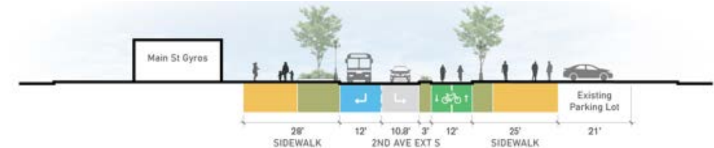
Hình 4.07. Khu Vực Trọng Điểm Stitch: Phần AA'. Hình ảnh minh họa phần tuyến phố tại 2nd Ave Ext S cho thấy các cải tạo đa phương thức được đề xuất, bao gồm cơ sở vật chất dành riêng cho xe đạp, vỉa hè mở rộng, cây xanh đường phố và các công trình thoát nước mưa.
